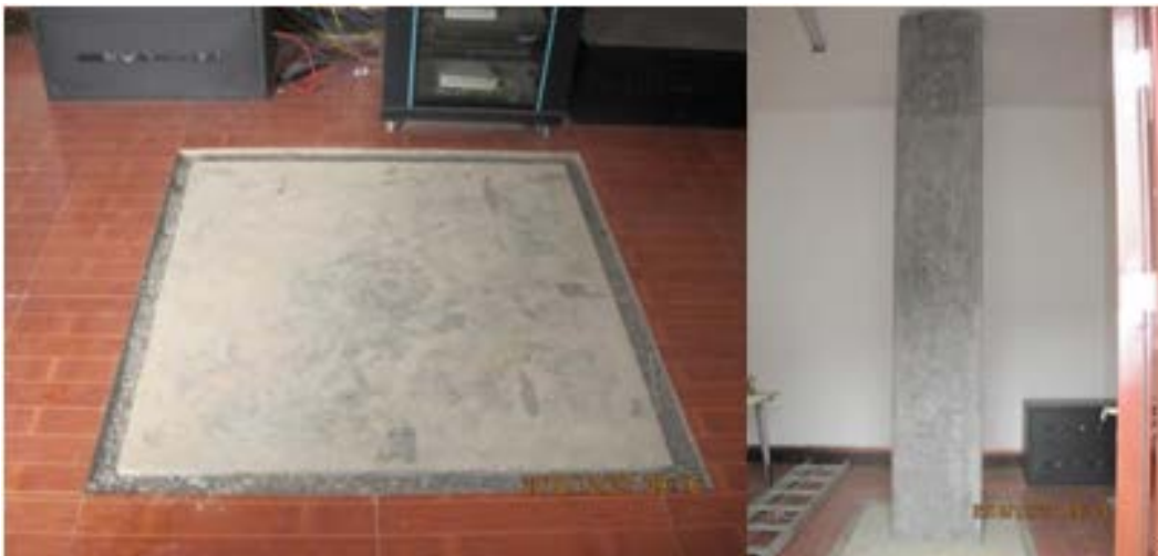
图 5.4.13 室内观测墩布设现状图
