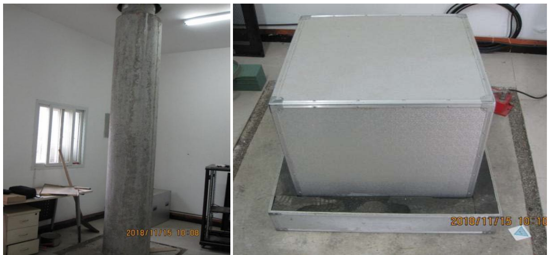
图 5.1.14 室内观测墩布设现状图
