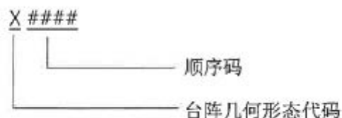
图 3 测点编码结构图
