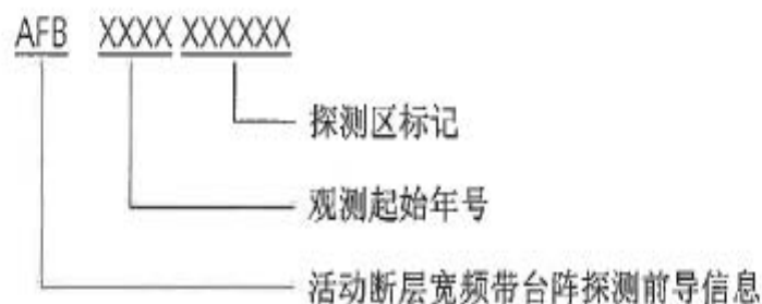
图 2 台阵编码结构图
